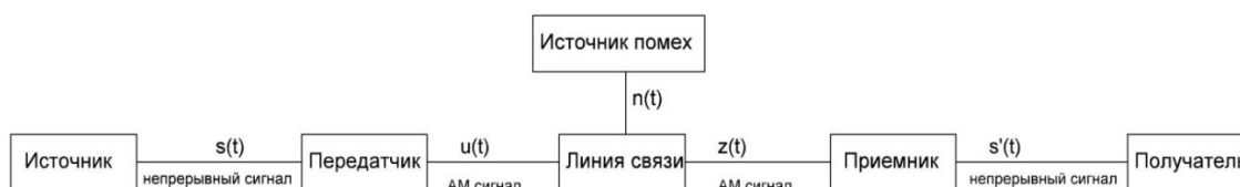
Рисунок 2. Функциональная схема системы связи
