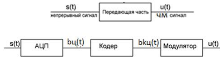
Рисунок 3. Функциональная схема передатчика сообщений
