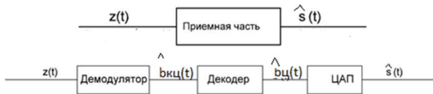
Рисунок 5. Функциональная схема приемника
